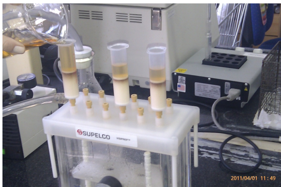
Rysunek 1. Ekstrakcja do fazy stałej na kolumnach z wypełnieniem C18 za pomocą stacji SUPELCO.
