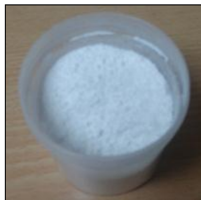
Rys. 1. Syntetyczny kompozyt ZnO-SiO 2 (fot. A. Laurentowska)
