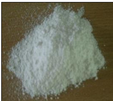
Rys. 1. Syntetyczny kompozyt ZnO-SiO 2 (fot. A. Laurentowska)
